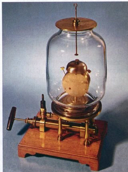
POMPA D'EPOCA Strumento del 1761 per dimostrare l'esistenza del vuoto: rimossa l'aria, la campana dell'orologio non si sente più.
